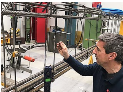
Verlijming van rekstrookjes op de internewapening
