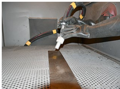
Stralen met Korund in het werk
