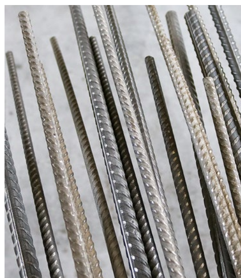
Geribdt staal vergelijkbaar met een materiaal 1.4003 volgens DIN EN 10088 (corrosieweerstandstandklasse 1)
