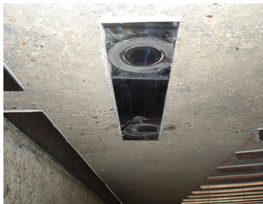
Koolstoflamel reststuk tbv Hechtsterkte meting
