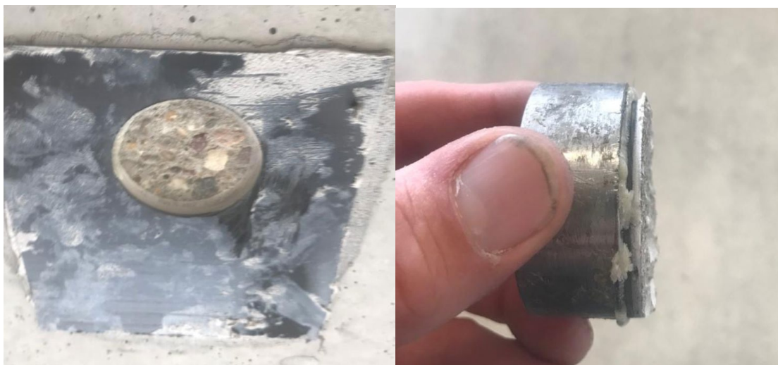
Figuur 6: Controle van de hechtsterkte d.m.v. de afbreekproef op afzonderlijke testzones
